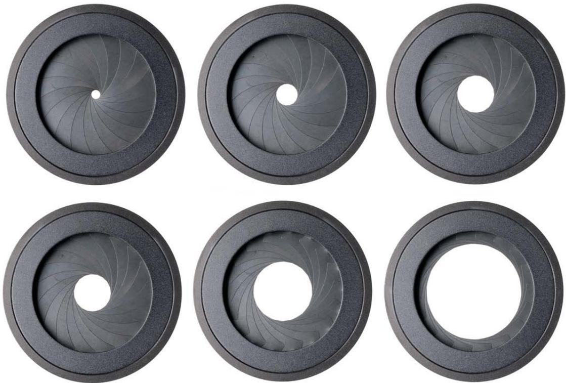
▲ Die X70 hat sechs volle Blendenstufen, von oben links nach unten rechts: f/2.8, f/4, f/5.6, f/8, f/11 und f/16. Beim FUJINON-X70-Objektiv können Sie nicht nur volle Blendenwerte einstellen, sondern die Blende auch in Drittelstufen anpassen.
