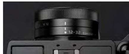
▲ Das kompakte Zoomobjektiv 12-32 mm lässt sich „zusammenfallen“. In dieser Position (in der Abbildung gezeigt) kann die Kamera zwar eingeschaltet, jedoch nicht verwendet werden! Drehen Sie den Objektivring nach rechts auf die erste Zoomposition (12 mm), um das Objektiv betriebsbereit herauszufahren.
