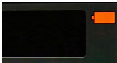
▲ Die Batterieanzeige wird rot und blinkt, wenn die verbleibende Akkuleistung zu gering wird. Schalten Sie die Kamera aus und machen Sie keine weiteren Aufnahmen!
