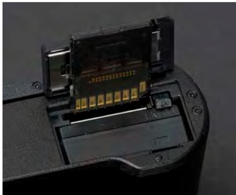
▲ Der SD-Speicherkartenslot befindet sich oberhalb des Akkueinschubs.
