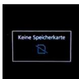
▲ Dieses Symbol erscheint nach dem Auslösen, wenn sich keine Speicherkarte im SD-Slot befindet. Außerdem zeigt das Bildzählwerk „----“ an.
