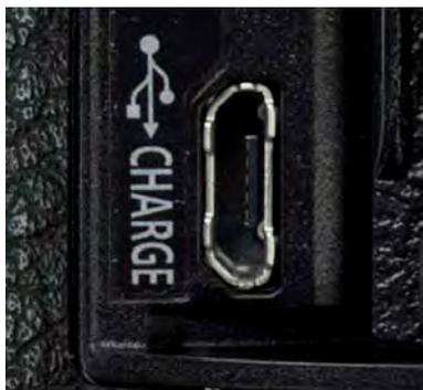
▲ Der Micro-USB-Anschluss für das mitgelieferte Ladekabel befindet sich hinter der seitlichen Schiebetür.
