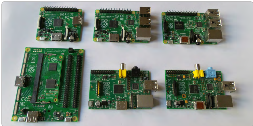
Bild 1.3: Oben: Raspberry Pi A+, Raspberry Pi B+, Raspberry Pi 2 – Unten: Compute Modul mit I/O-Platine, Raspberry Pi B altes Modell, Raspberry Pi B neues Modell (auf älteren Platinen fehlen die beiden auffälligen Schraublöcher sowie die beiden Lötösen für den Reset-Schalter links des HDMI-Anschlusses)
