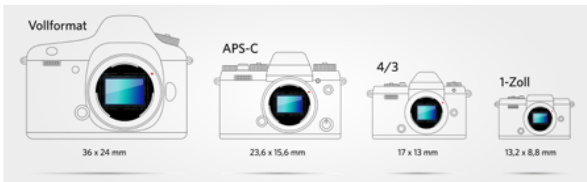
▲ Sensorvergleich: Vollformat-, APS-C-, Micro-Four-Thirds- und 1-Zoll-Sensor.
