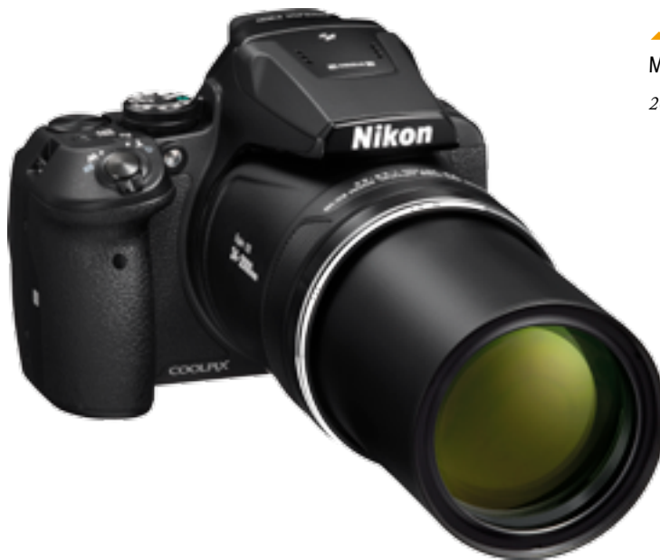
▲ Die Nikon COOLPIX P900 mit 1/2,3-Zoll-CMOS-Sensor und einer Brennweite von 4,3 bis 357 mm. Das entspricht auf das Kleinbildformat umgerechnet einem Bildwinkel von sagenhaften 24 bis 2000 mm.
