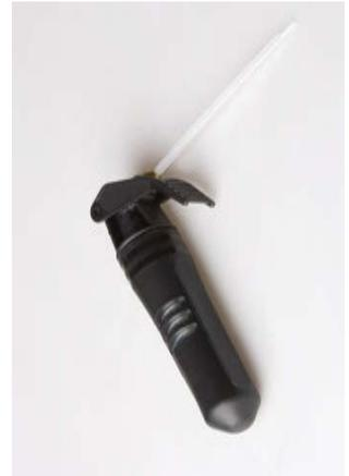
*Reinigungsgeräte gibt es verschiedene. Zumindest ein geeignetes Tuch sollte immer dabei sein. Ebenfalls zu empfehlen sind ein Reinigungspinsel und ein Blasebalg oder – wie in der Abbildung zu sehen – ein kleines Druckluftgerät zum Reinigen des Objektivs.*
