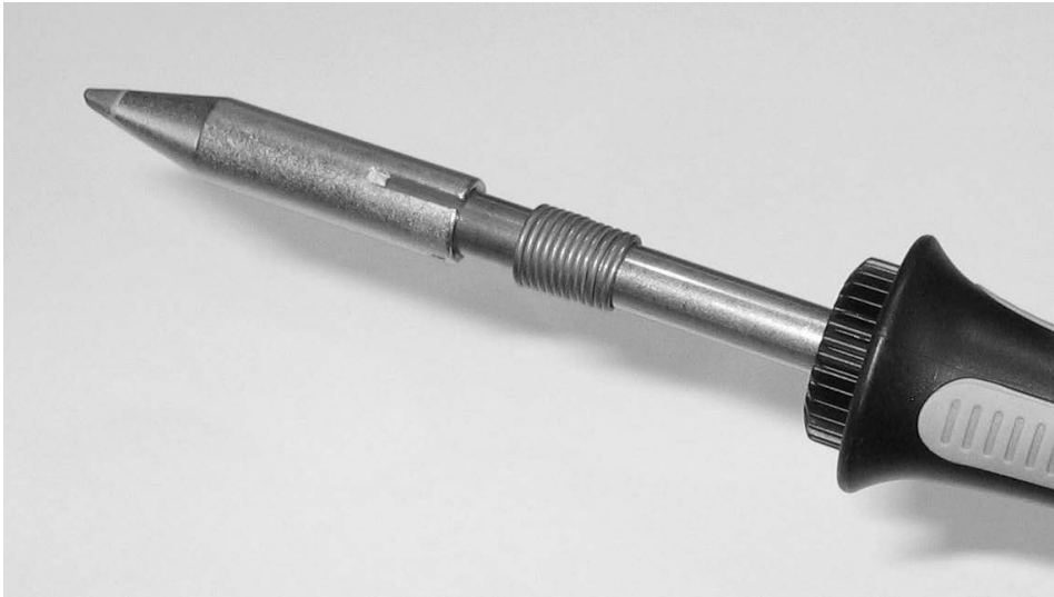
Abb. 15.10 – Im Griff dieses Lötkolbens sind drei Fingerablageflächen aus Gummi eingearbeitet, um ein Abrutschen zu verhindern.
