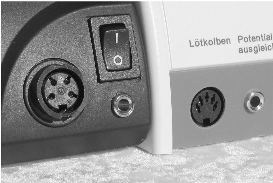
Abb. 15.1 – Unterschiedliche Buchsen in den Basisstationen verhindern, dass der Anwender einen nicht zur Steuereinheit passenden LötKolben anschließt.
