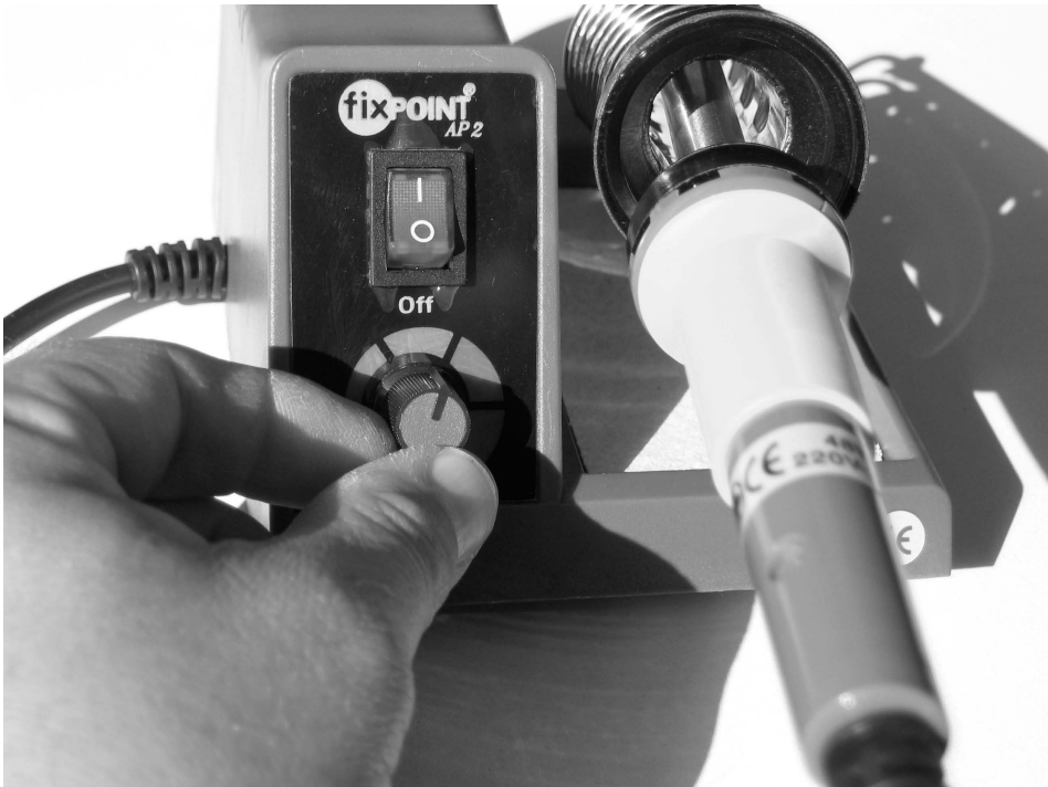
Abb. 15.3 – Bei dieser preiswerten Lötstation ist die Arbeitstemperatur nicht exakt einstellbar, weil die Temperaturangaben fehlen.
