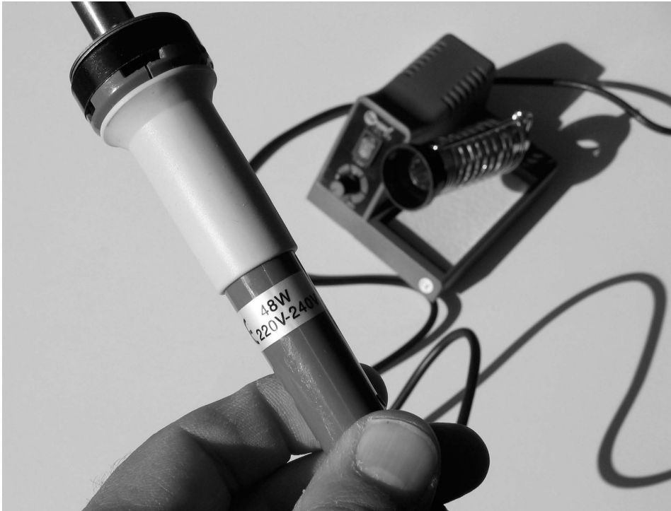
Abb. 15.8 – ...aber am LötKolben selbst ist eine Betriebsspannung von 230 V angegeben.
