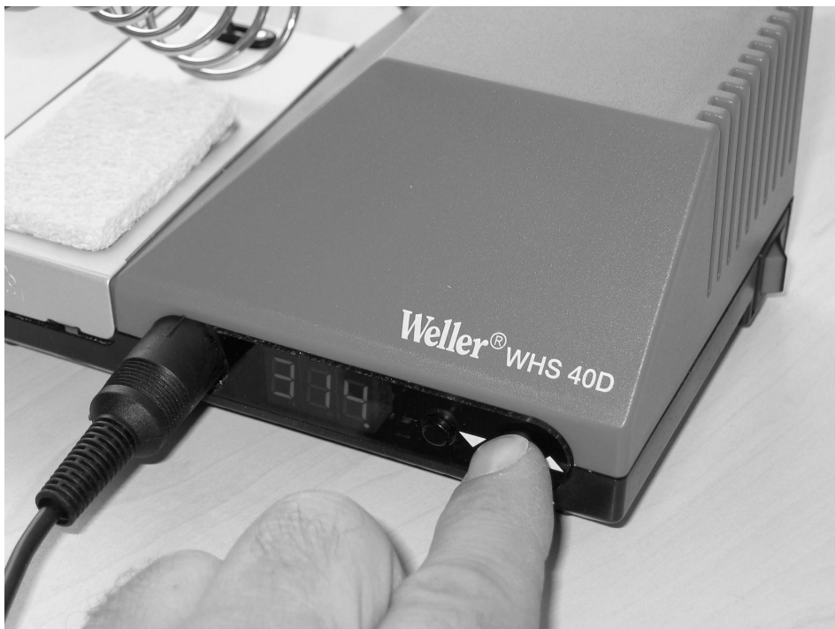
Abb. 15.4 – Mit Tasten können Sie bei Geräten der gehobenen Mittelklasse die Löttemperatur gradgenau auswählen, programmieren und auf Tastendruck wieder abrufen.
