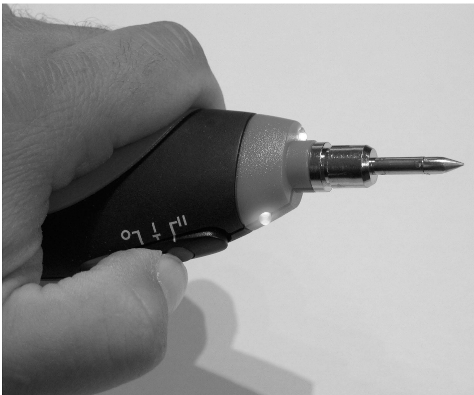
Abb. 1.13 – Damit sich der Batterie-LötKolben aufheizt, ist der Taster am Schiebeschalter gedrückt zu halten. Zwei Leuchtdioden zeigen den Betriebsstatus an.
