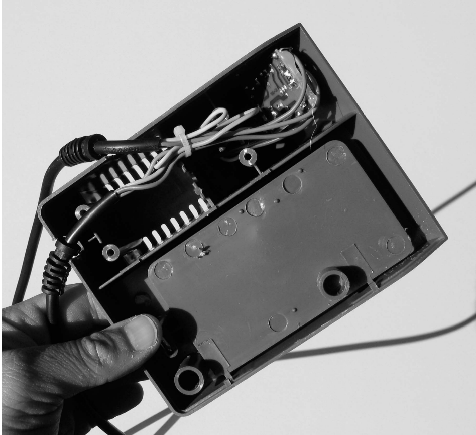
Abb. 15.9 – Das Innenleben der einfachen Lötstation bringt Gewissheit: Der Trafo für die ungefährliche Sicherheitskleinspannung fehlt. Der Lötkolben braucht also 230 V Netzspannung, um zu funktionieren.
