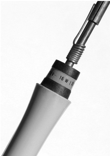
Abb. 1.6 – Feinlötkolben mittlerer Größe. Er ist an der Leistungsaufnahme von 16 W zu erkennen.
