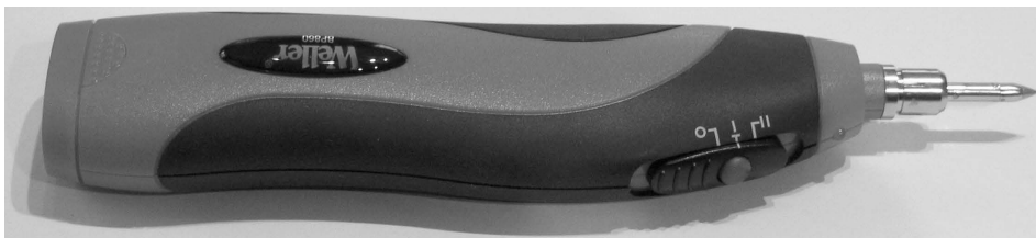
Abb. 1.12 – Ein batteriebetriebener LötKolben mit einer Lötspitze in Bleistiftspitzenform, die sich für punktgenaue Lötungen an sehr kleinen Bauteilen und IC-Anschlüssen eignet.
