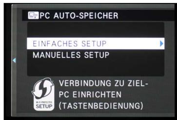
▶ Wer eine Verbindung zwischen Kamera und Computer herstellen möchte, um die Bilder direkt darauf zu speichern, muss über den Menüpunkt *PC AUTO-SPEICHER* erst einmal die Verbindung konfigurieren. Dazu stehen zwei Möglichkeiten zur Verfügung: das einfache und ein manuelles Setup. Voraussetzung ist, dass man die Fujifilm-Software »PC AutoSave« auf dem Computer gespeichert hat.
