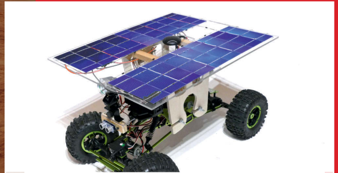
Solaranlage zum Laden des Akkus
